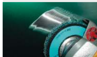
Usuwanie powłok malarskich
