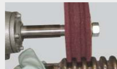
Oczyszczanie trudno dostępnych miejsc
