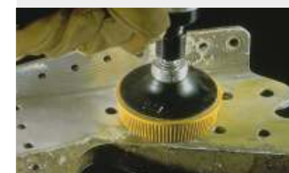
Usuwanie powłok malarskich
