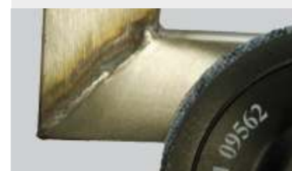
Wyrównywanie nierówności powierzchni po materiale nasypowym
